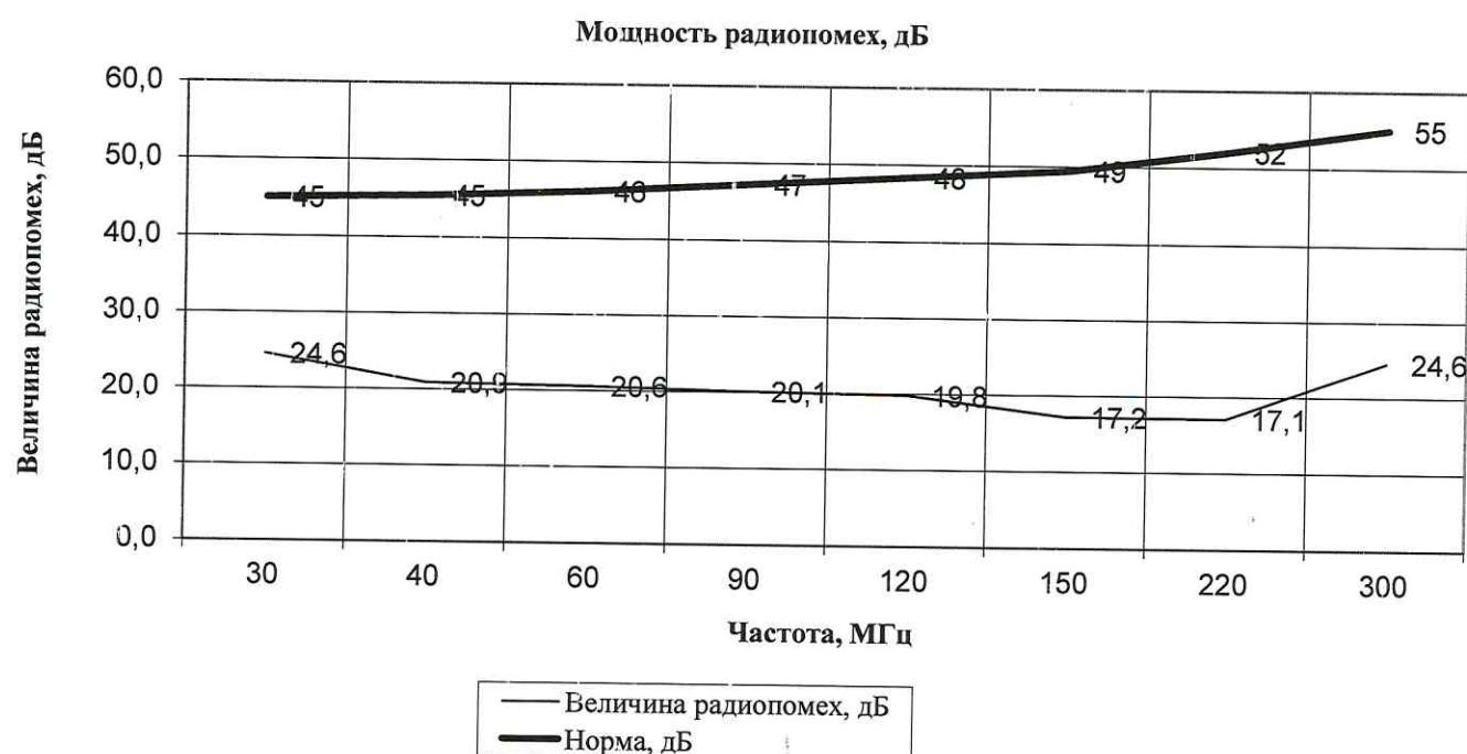
**Таблица измерений мощности радиопомех в сетевом шнуре
