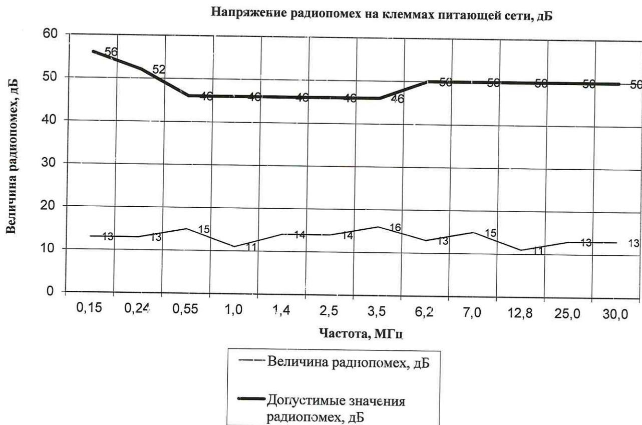
**Таблица измерений мощности радиопомех в сетевом шнуре
