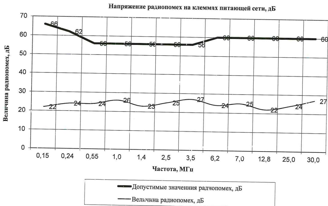
**Таблица измерений напряжения радиопомех на клеммах питающей сети
